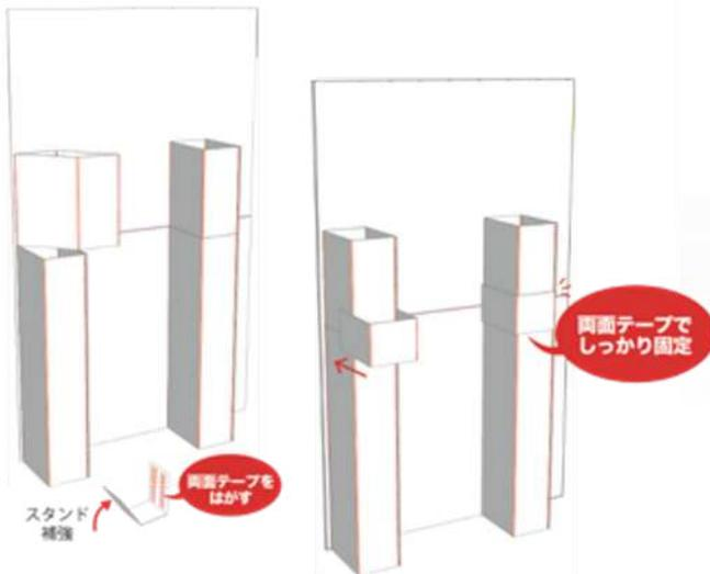
**3** 底パーツを組み立てスタンドの間に設置します。
