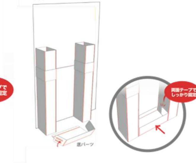
**4** もう一つのパネルも同じ手順で組み立て、左右を確認し、なるべく隙間ができない様に並べます。間に補強材を貼り固定したら完成です。
